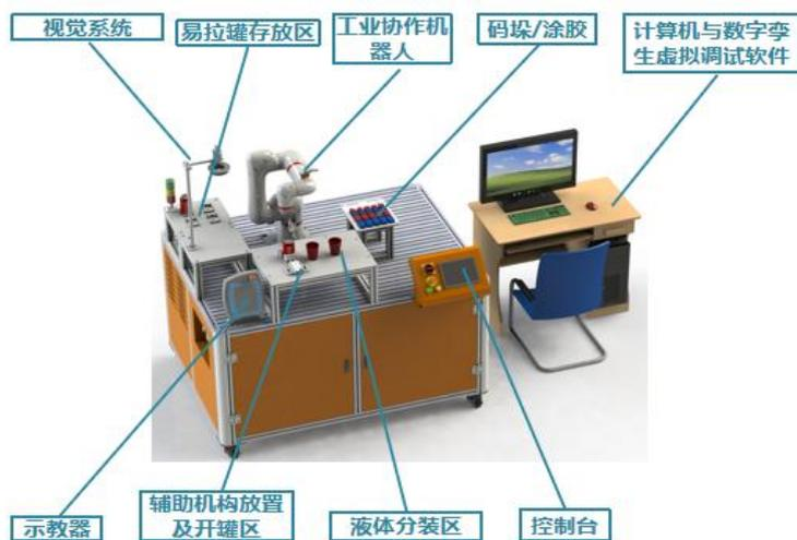
图1 工业协作机器人及数字孪生技术创新应用平台
